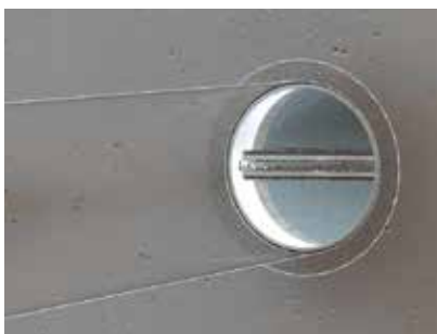
Das Brandschutzelement wird in einem Lüftungsrohr aus Metall mit dem gleichen Durchmesser und mit einer Gummidichtung eingesetzt. Beide Teile des Klappenblatts werden vom Schmelzlot in der geöffneten Stellung gehalten.
