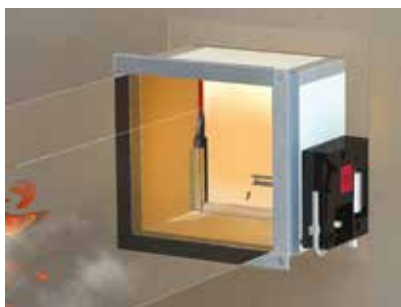
Ein Feuer bricht aus und die Temperatur erreicht 72 °C. Das Schmelzlot schmilzt und das Klappenblatt schließt sich.
